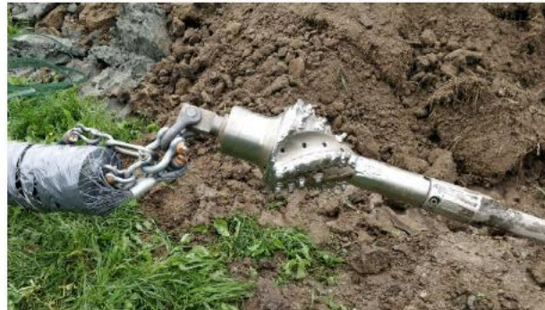
Grabenlose Verlegung im günstigen Spülbohrverfahren
